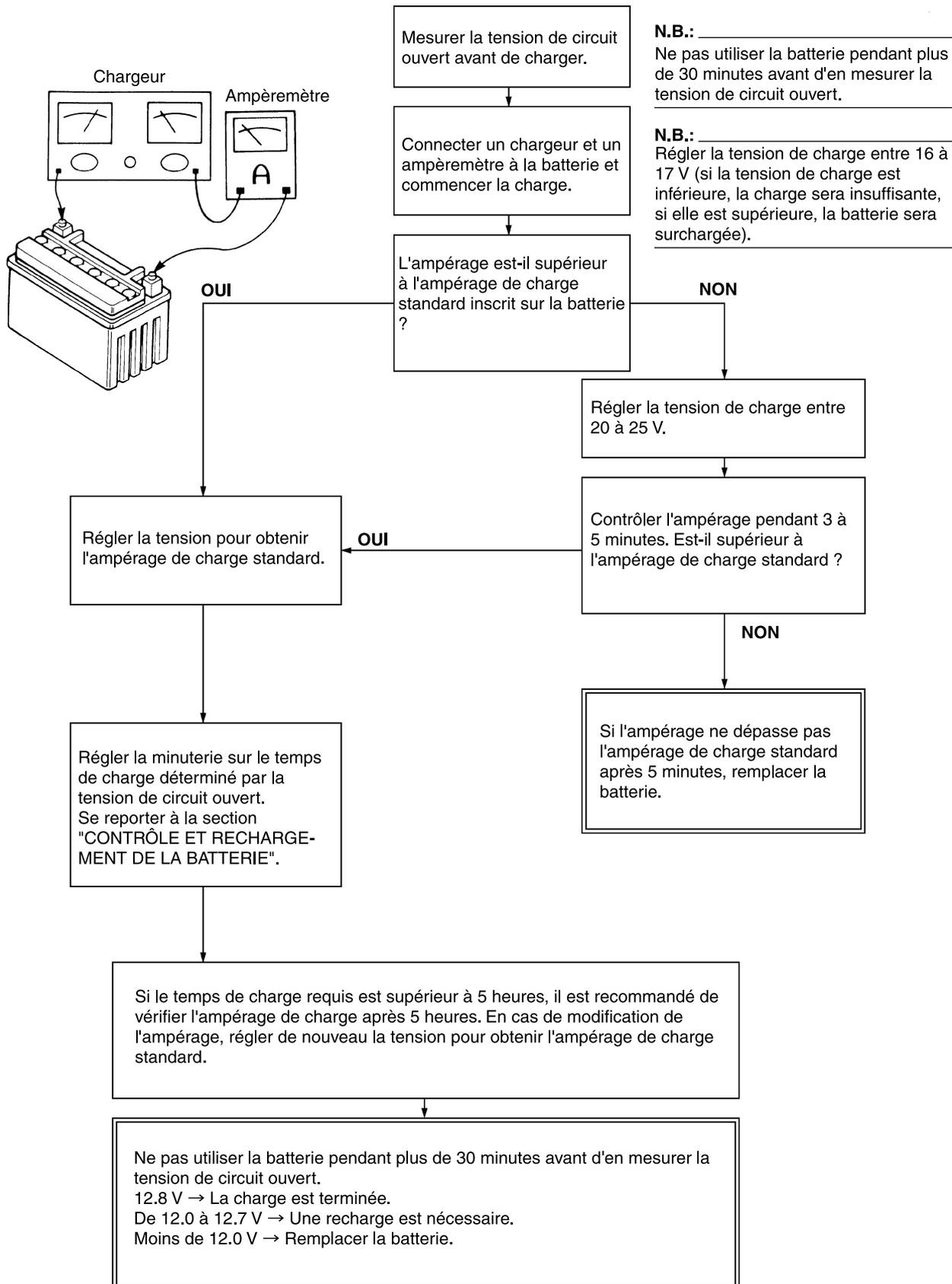
**Méthode de charge à l'aide d'un chargeur à tension constante**
