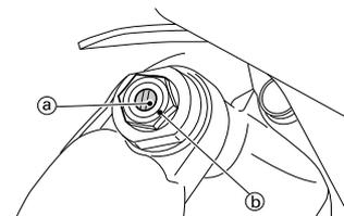
**RÉGLAGE DE LA FORCE D'AMORTISSEMENT À LA COMPRESSION HAUTE DE L'AMORTISSEUR ARRIÈRE**
