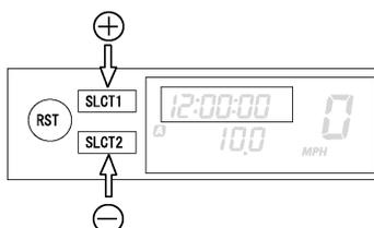
4. Pour terminer le réglage, appuyer sur le bouton "RST" pendant 2 secondes minimum.
