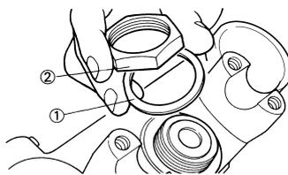
10. Après avoir serré l'écrou, vérifier si le mouvement de la direction est régulier. Sinon, régler la direction en desserrant petit à petit l'écrou.
