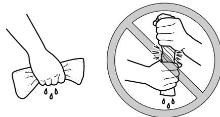
4. Die gesamte Oberfläche des Filterschaumstoffs mit dem vorgeschriebenen Öl benetzen und dann überschüssiges Öl ausdrücken.
