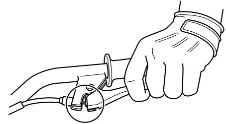
Die Hebelrehpunkte der Vorderrad- und Hinterrad-Bremshebel sollten in den empfohlenen Abständen gemäß Wartungs- und Schmiertabelle geschmiert werden.
