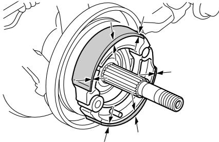
Misst die Stärke eines Trommelbremsbelags weniger als 1.5 mm (0.06 in), die Trommelbremsbeläge im Satz von einer Yamaha-Fachwerkstatt austauschen lassen.
