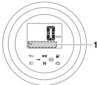
1. Contachilometri totalizzatore/contachilometri parziale/contachilometri parziale per il carburante di riserva/orologio
