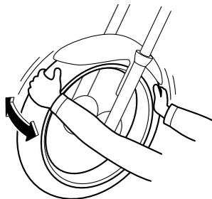
6 Si devono controllare i cuscinetti ruota anteriore e posteriore agli intervalli specificati nella tabella della manutenzione periodica e lubrificazione. Se c'è del gioco nel mozzo ruota, o se la ruota non gira agevolmente, fare controllare i cuscinetti ruote da un concessionario Yamaha.
