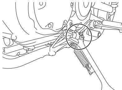
Prima di utilizzare il mezzo, controllare sempre il funzionamento del cavalletto laterale, e lubrificare, se necessario, il perno di guida del cavalletto laterale e le superfici di contatto metallo/metallo.
