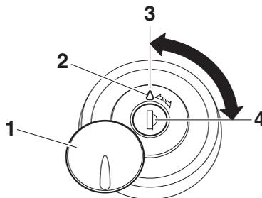
1. Coperchietto della serratura tappo serbatoio carburante
