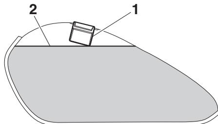
1. Tubo di rifornimento del serbatoio del carburante
