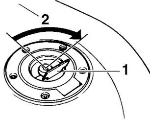
1. Cubierta de la cerradura del tapón del depósito de gasolina
