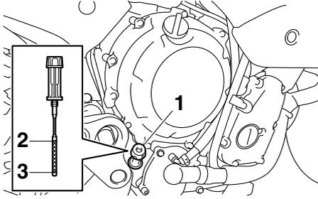
1. Varilla de medición del aceite del motor
