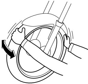
Debe comprobar los cojinetes de las ruedas delantera y trasera según los intervalos que se especifican en el cuadro de mantenimiento periódico y engrase. Si el cubo de la rueda se mueve o si no gira con suavidad, solicite a un concesionario Yamaha que revise los cojinetes de la rueda.
