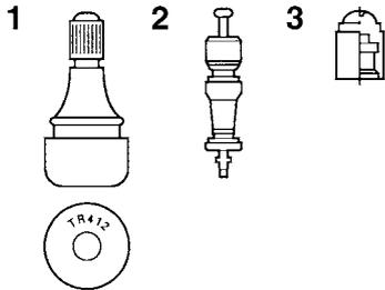
1. Válvula de aire del neumático
