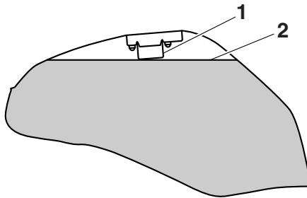
1. Tubo de llenado del depósito de gasolina
