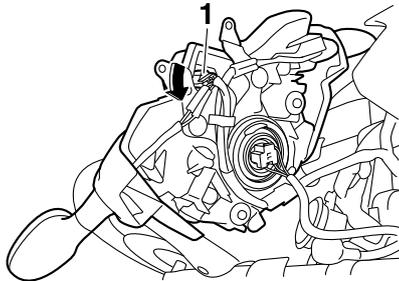
1. Acoplador de la luz de posición
