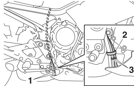
1. Tubo respiradero y tubo de rebose del depósito de gasolina
