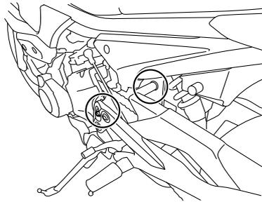
Los pivotes del basculante se deben engrasar en un concesionario Yamaha según los intervalos que se especifican en el cuadro de mantenimiento periódico y engrase.
