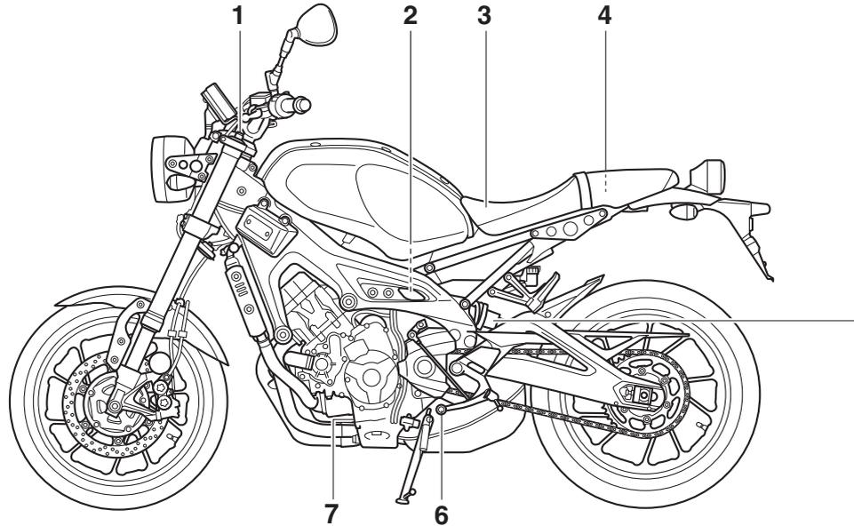
1. Perno de ajuste de la precarga del muelle de la horquilla delantera (página 3-23)
