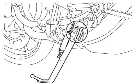
Antes de cada utilización debe comprobar el funcionamiento del caballete lateral y engrasar el pivote y las superficies de contacto metal-metal si es necesario.
