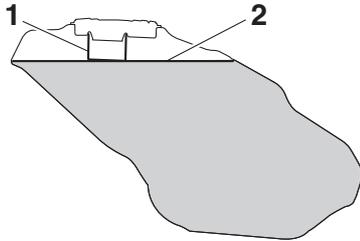
1. Tubo de llenado del depósito de gasolina
