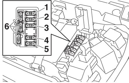
1. Fusible del motor del ventilador del radiador
