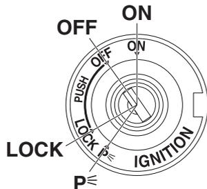
El interruptor principal/bloqueo de la dirección controla los sistemas de encendido y luces y se utiliza para bloquear la dirección. A continuación se describen las diferentes posiciones.
