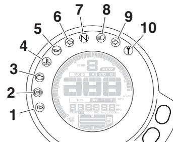
1. Luz indicadora del sistema de control de tracción “TCS”
