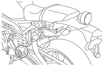
Los pivotes del basculante se deben engrasar en un concesionario Yamaha según los intervalos que se especifican en el cuadro de mantenimiento periódico y engrase.
