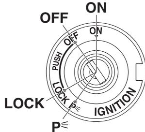
O interruptor principal/bloqueio da direção controla os sistemas de ignição e iluminação, e é utilizado para bloquear a direção. As várias posições são descritas a seguir.
