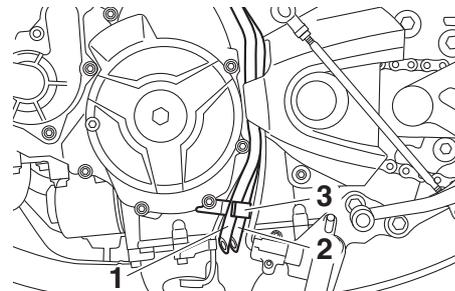
1. Tubo de descarga do depósito de combustível
