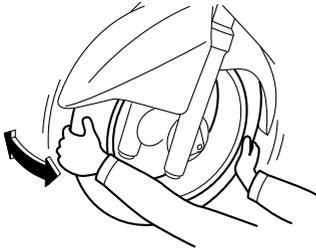
Die Vorder- und Hinterradlager müssen in den empfohlenen Abständen gemäß Wartungs- und Schmiertabelle geprüft werden. Falls ein Radlager zu viel Spiel aufweist oder das Rad nicht leichtgängig dreht, die Radlager von einer Yamaha-Fachwerkstatt überprüfen lassen.
