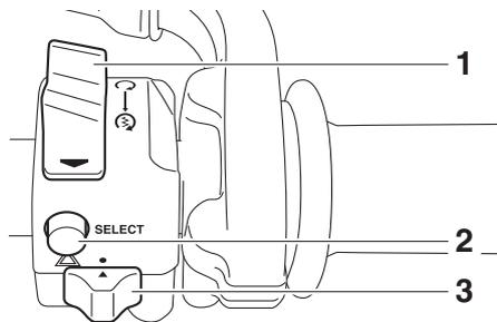
1. Interruptor de arranque/paro del motor “ $\text{motor}/\bigcirc/\text{emergencia}$ ”
