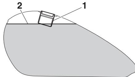
1. Tubo de llenado del depósito de gasolina
