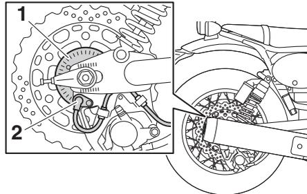
1. Rotor del sensor de la rueda trasera
