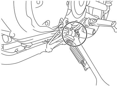
Antes de cada utilización debe comprobar el funcionamiento del caballete lateral y engrasar el pivote y las superficies de contacto metal-metal si es necesario.
