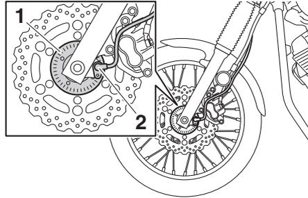
1. Rotor del sensor de la rueda delantera
