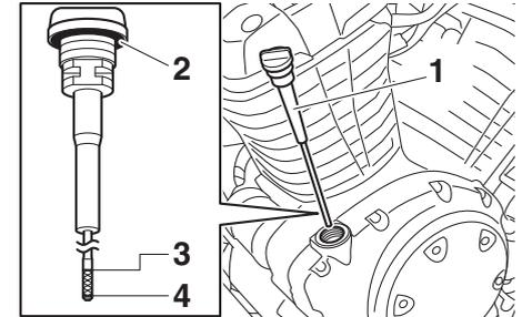
1. Varilla de medición del aceite del motor
