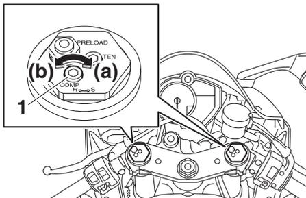
1. Cavilha ajustadora da força amortecedora de compressão
