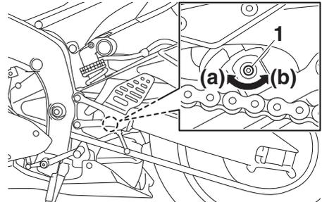
1. Cavilha ajustadora da força amortecedora de recuo
