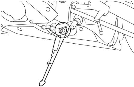
Antes de cada viagem, deverá verificar o funcionamento do descanso lateral e, se necessário, deverá lubrificar o pivô do descanso lateral e as superfícies de contacto de metal com metal.
