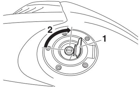
1. Cobertura da fechadura da tampa do depósito de combustível
