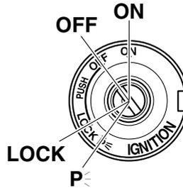
O interruptor principal/bloqueio da direção controla os sistemas de ignição e iluminação, e é utilizado para bloquear a direção. As várias posições são descritas a seguir.
