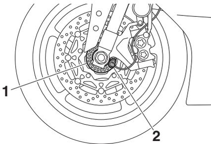
1. Rotor do sensor da roda da frente
