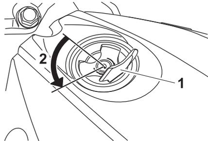
1. Cobertura da fechadura da tampa do depósito de combustível
