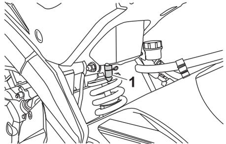
1. Tubo de inspeção do filtro de ar
