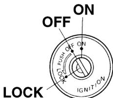
O interruptor principal/bloqueio da direção controla os sistemas de ignição e iluminação, e é utilizado para bloquear a direção. As várias posições são descritas a seguir.
