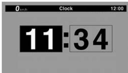
3. Stellen Sie die Stundenangabe ein, indem Sie das Drehrädchen drehen und anschließend kurz drücken.
