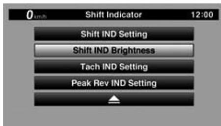
Wählen Sie die Option “Shift IND Brightness” aus, und passen Sie die Einstellung mit dem Drehrädchen wie gewünscht an. Drücken Sie kurz auf das Drehrädchen, um die Einstellung zu bestätigen und den Bildschirm zu verlassen.
