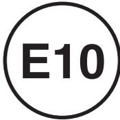
hol mit Äthanol kann verwendet werden, wenn der Äthanolgehalt 10% (E10) nicht überschreitet. Gasohol mit Methanol wird nicht von Yamaha empfohlen, weil es das Kraftstoffsystem beschädigen oder die Fahrzeugleistung beeinträchtigen kann.
