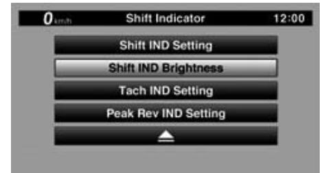
Wählen Sie die Option "Shift IND Brightness" aus, und passen Sie die Einstellung mit dem Drehrädchen wie gewünscht an. Drücken Sie kurz auf das Drehrädchen, um die Einstellung zu bestätigen und den Bildschirm zu verlassen.
