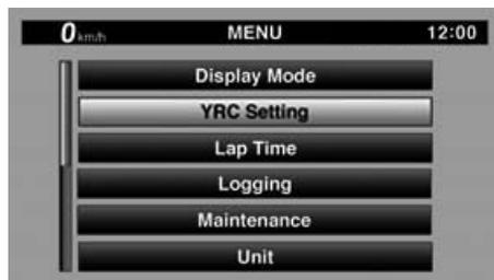
2. Daraufhin wird der Bildschirm "YRC Setting" angezeigt, und das Feld für den YRC-Modus "YRC" wird hervorgehoben. Drücken Sie kurz auf das Drehrädchen, um in das Feld zu wechseln, und wählen Sie den YRC-Modus aus, den Sie einstellen möchten (A, B, C oder D).
