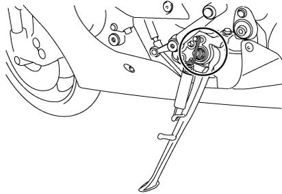
Die Funktion des Seitenständers sollte vor jeder Fahrt geprüft werden und die Drehpunkte und Metall-auf-Metall-Kontaktflächen sollten gegebenenfalls geschmiert werden.
