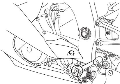
Vor Fahrtantritt die Funktion der Fußbrems- und Schalthebel prüfen und ggf. die Drehpunkte schmieren.
