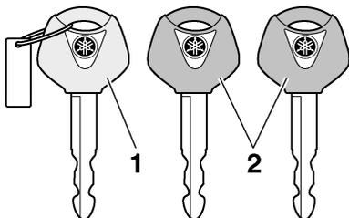
1. Schlüssel für die Re-Registrierung des Codes (rote Ummantlung)
