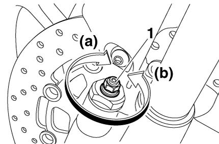
1. Druckstufendämpfungs-Einstellschraube (für langsame Dämpfung)
