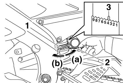
1. Einstellung der Federvorspannung
