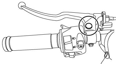
Vor Fahrtantritt die Funktion der Handbrems- und Kupplungshebel prüfen und ggf. die Drehpunkte schmieren.
