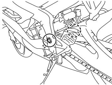
Die Schwingen-Drehpunkte müssen in den vorgeschriebenen Abständen geschmiert werden, gemäß der Tabelle für regelmäßige Wartung und Schmierung.
