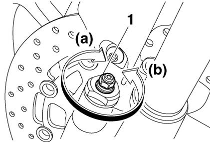
1. Perno de ajuste del hidráulico de compresión (para una amortiguación rápida en compresión)
