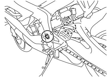
Los pivotes del basculante se deben lubricar según los intervalos que se especifican en el cuadro de mantenimiento periódico y engrase.
