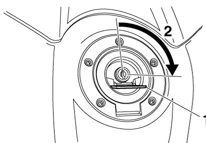
1. Cubierta de la cerradura del tapón del depósito de gasolina
