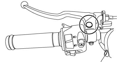
Cada vez que conduzca, debe antes verificar el funcionamiento de las manetas de freno y embrague y engrasar los pivotes de las manetas si es necesario.
