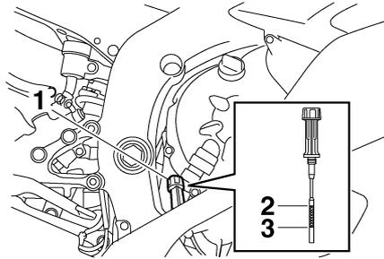
1. Varilla de medición del aceite del motor
