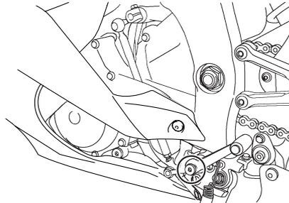
Cada vez que conduzca, compruebe antes el funcionamiento de los pedales de freno y cambio y engrase los pivotes de los pedales si es necesario.
