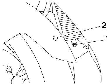
1. Tornillo de fijación rápida
