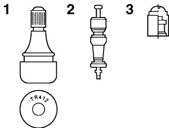
1. Válvula de aire del neumático
