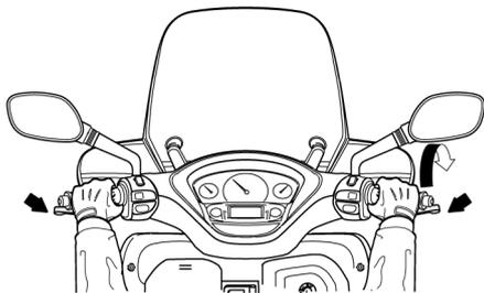
1. Chiudere completamente l'acceleratore.
