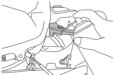
I punti di rotazione delle leve del freno anteriore e posteriore vanno lubrificati agli intervalli specificati nella tabella della manutenzione periodica e lubrificazione.
