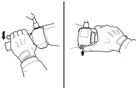
3. Accendere il motore premendo l'interruttore di avviamento ed azionando il freno anteriore o posteriore.
