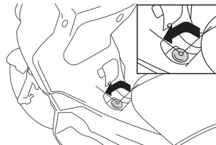
Aprire il coperchio tirando in alto la leva. Inserire la chiave nella serratura tappo serbatoio carburante e girarla di 1/4 di giro in senso antiorario. La serratura si apre e si può togliere il tappo del serbatoio del carburante.
