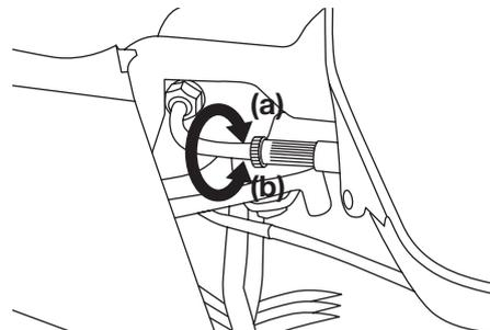
3. Per aumentare il gioco del cavo dell'acceleratore, girare il dado di regolazione in direzione (a). Per ridurre il gioco del cavo dell'acceleratore, girare il dado di regolazione in direzione (b).
