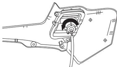
4. Togliere la lampadina guasta premendola e girandola in senso antiorario.
