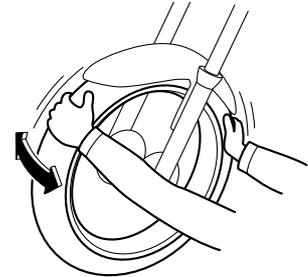
Die Vorder- und Hinterradlager müssen in den empfohlenen Abständen gemäß Wartungs- und Schmiertabelle geprüft werden. Falls ein Radlager zu viel Spiel aufweist oder das Rad nicht leichtgängig dreht, die Radlager von einer Yamaha-Fachwerkstatt überprüfen lassen.
