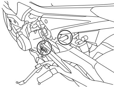
Die Schwingen-Drehpunkte müssen in einer Yamaha-Fachwerkstatt in den vorgeschriebenen Abständen geschmiert werden, gemäß der Tabelle für regelmäßige Wartung und Schmierung.
