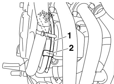
1. Entlüftungsschlauch des Kühlflüssigkeits-Ausgleichsbehälters
