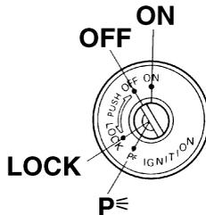
Das Zünd-/Lenkschloss verriegelt und entriegelt den Lenker und schaltet die Zündung sowie die Stromversorgung der anderen elektrischen Systeme ein und aus. Die einzelnen Schlüsselstellungen sind nachfolgend beschrieben.
