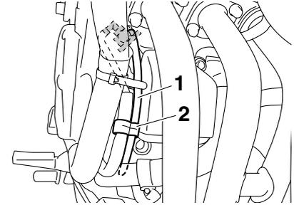
1. Entlüftungsschlauch des Kühlflüssigkeits-Ausgleichsbehälters
