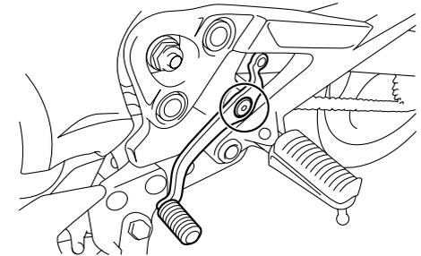
Vor Fahrtantritt die Funktion der Fußbrems- und Schalthebel prüfen und ggf. die Drehpunkte schmieren.
