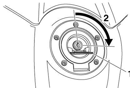
1. Cache-serrure du bouchon de réservoir de carburant
