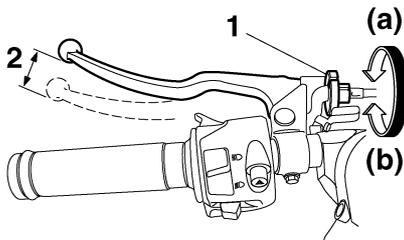
1. Vis de réglage de la garde du levier d'embrayage
