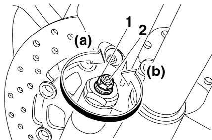
1. Vis de réglage de la force d'amortissement à la compression (pour un amortissement rapide)
