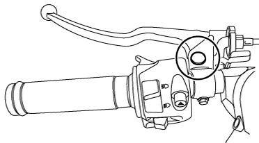
Contrôler le fonctionnement du levier de frein et d'embrayage avant chaque départ et lubrifier les articulations de levier quand nécessaire.
