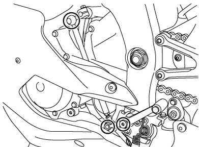
Contrôler le fonctionnement de la pédale de frein et du sélecteur avant chaque départ et lubrifier les articulations quand nécessaire.
