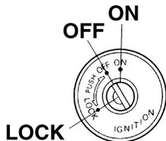
O interruptor principal/bloqueio da direcção controla os sistemas de ignição e iluminação, e é utilizado para bloquear a direcção. As várias posições são descritas a seguir.
