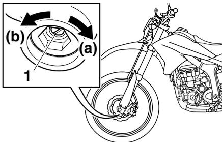
1. Parafuso ajustador da força amortecedora de compressão
