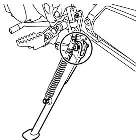
Antes de cada viagem, deverá verificar o funcionamento do descanso lateral e, se necessário, deverá lubrificar o pivô do descanso lateral e as superfícies de contacto de metal com metal.
