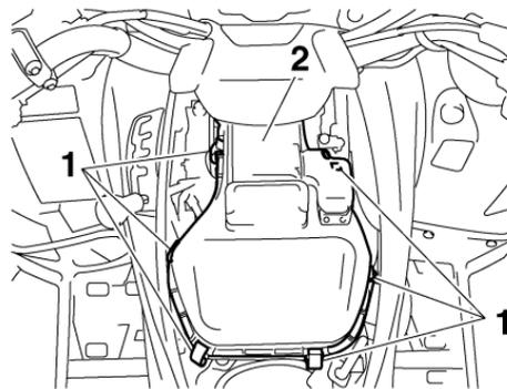
1. Attache du boîtier de filtre à air
