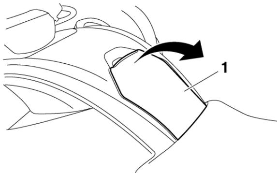
1. Cache du bouchon de réservoir de carburant
