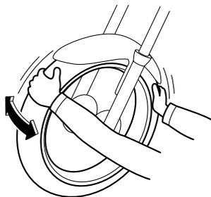
Os rolamentos de roda dianteiros e traseiros têm de ser verificados nos intervalos de tempo especificados na tabela de lubrificação e manutenção periódica. Se houver uma folga no cubo da roda ou se a roda não virar suavemente, solicite a um concessionário Yamaha que verifique os rolamentos de roda.
