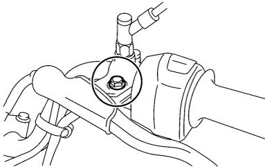
Antes de cada viagem, deverá verificar o funcionamento das alavancas do travão e da embraiagem e, se necessário, deverá lubrificar os pivôs da alavanca.
