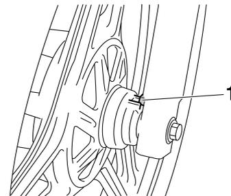
1. Retentor do módulo de engrenagens do velocímetro
