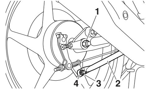
1. Desaperte a porca do eixo e a porca do tirante de binário do travão na placa de sapata do travão.
