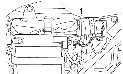
1. Acoplador do relé do motor de arranque
