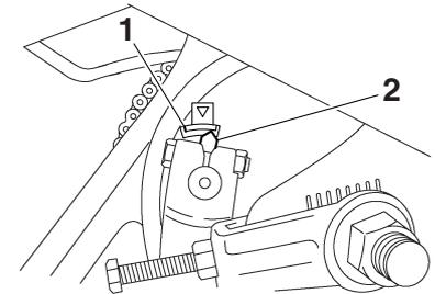
1. Marca do limite de desgaste da sapata do travão
