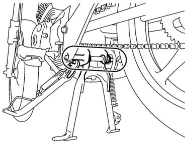
6 Antes de cada viagem, deverá verificar o funcionamento dos descansos central e lateral e, se necessário, deverá lubrificar os pivôs e as superfícies de contacto de metal com metal.
