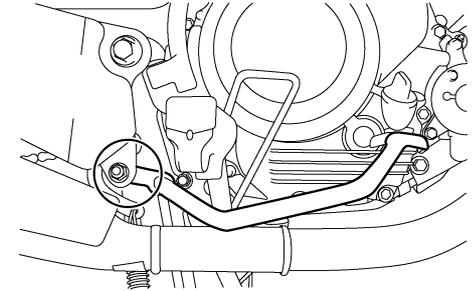
Antes de cada viagem, deverá verificar o funcionamento dos pedais do travão e, se necessário, deverá lubrificar os pivôs dos pedais.
