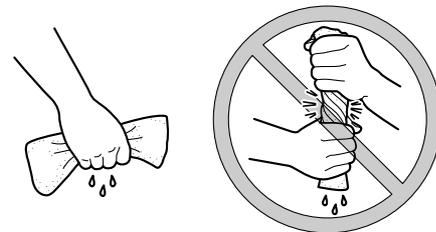
7. Instale o material esponjoso no elemento do filtro de ar e, depois, instale o elemento do filtro de ar na caixa do filtro de ar. **PRECAUÇÃO: Certifique-se de que o elemento do filtro de ar está devidamente fixo na caixa do filtro de ar. O motor nunca deve ser colocado em funcionamento sem o elemento do filtro de ar instalado, caso contrário o(s) pistão(ões) e/ou cilindro(s) poderão desgastar-se excessivamente.** [PCA10481]
