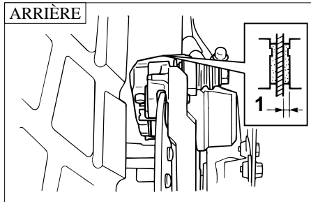
1. Indicateur d'usure: 0.8 mm
