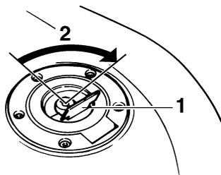
1. Coperchietto della serratura del serbatoio carburante
