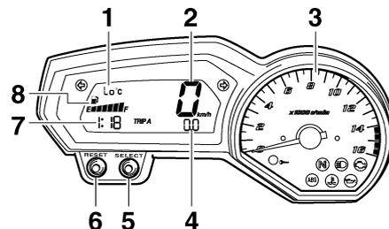
1. Display temperatura liquido refrigerante/display temperatura aria aspirazione
