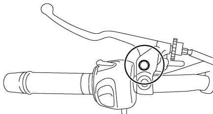
Prima di utilizzare il mezzo, controllare sempre il funzionamento delle leve freno e frizione e lubrificare, se necessario, i perni di guida delle leve.
