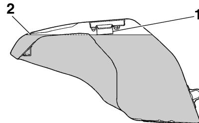
1. Tubo di rifornimento del serbatoio del carburante
