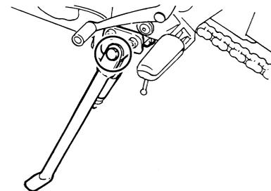
Prima di utilizzare il mezzo, controllare sempre il funzionamento del cavalletto laterale, e lubrificare, se necessario, il punto di rotazione del cavalletto laterale e le superfici di contatto metallo/metallo.
