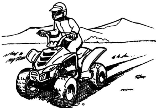
Si les roues arrière commencent à déraper, il est possible de regagner le contrôle du véhicule (si l'espace disponible est suffisant) en manœuvrant dans la direction du dérapage. Il est déconseillé de freiner ou d'accélérer avant d'avoir repris le contrôle du véhicule.
