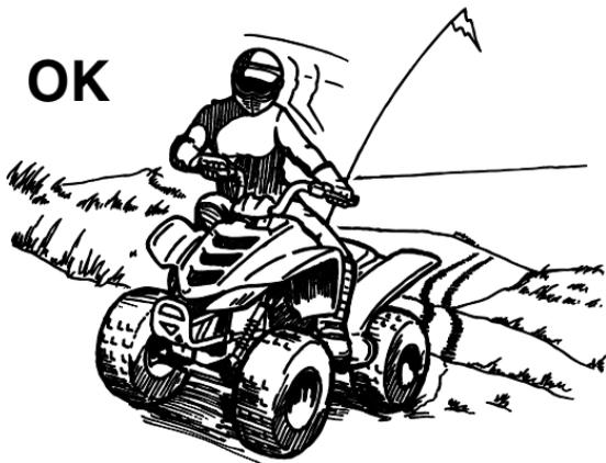
Si le VTT a calé ou s'il s'est arrêté et que l'on juge pouvoir atteindre le sommet de la côte, redémarrer prudemment afin que les roues avant ne se soulèvent pas, car cela entraînerait la perte de contrôle du véhicule. S'il est impossible de continuer l'ascension, descendre du VTT. Tourner le VTT en le poussant, puis redescendre la colline.
