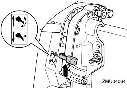
4. Reggete con una mano il retro della candelabra, sollevate il motore e ruotate la leva di supporto tilt verso di voi, oppure infilate la manopola di supporto tilt nella staffa di bloccaggio, quindi rimettete la leva di blocco/sblocco tilt nella posizione di bloccaggio per sostenere il motore fuoribordo.
