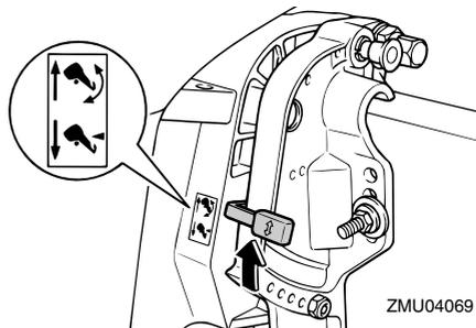
2. Reggete con una mano il retro della calandra, alzate leggermente il motore fuoribordo ed estraete la manopola di supporto tilt o rigirate la leva di supporto tilt.
