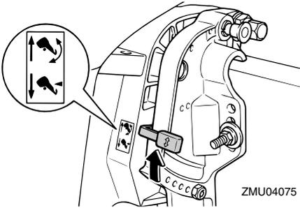
3. Sollevate leggermente il motore fuoribordo fino a portarlo nella posizione desiderata e abbassate la leva di blocco/sblocco tilt nella posizione di bloccaggio.
