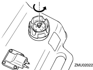
2. Se il motore ha il giunto del carburante, collegate saldamente ad esso il condotto del carburante. Quindi collegate saldamente l'altra estremità del giunto del carburante al serbatoio del carburante.
