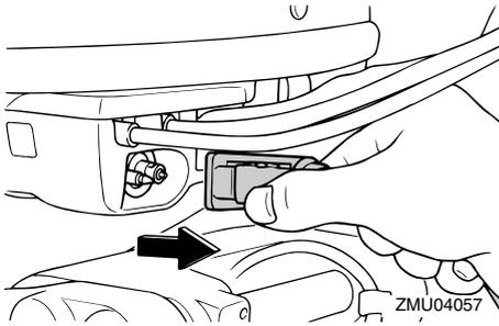
3. Chiudete la vite di sfiato dell'aria sul tappo del serbatoio del carburante (se presente).
