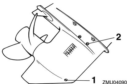
1. Vite di scarico dell'olio ingranaggi
