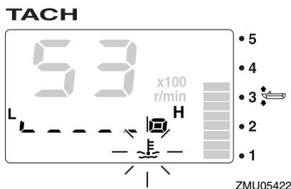
Arrêtez immédiatement le moteur si le vibreur retentit et si le dispositif d'avertissement de surchauffe est activé. Vérifiez si l'entrée d'eau de refroidissement n'est pas obstruée.
