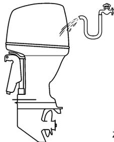
2. Fate scorrere via completamente dal motore l'acqua di raffreddamento. Pulitene a fondo il corpo.
