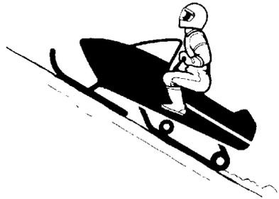
Ne pas se laisser surprendre par un obstacle invisible du pied de la côte. Ralentir à l'approche de la crête, et se préparer à éviter un obstacle, à négocier un virage ou à entamer une descente. Si la pente devient trop raide et qu'il n'est pas possible de la franchir, ne pas laisser patiner la chenille. Couper le moteur et mettre le frein de stationnement. Tourner la motoneige vers la descente, en tirant sur l'ar-
