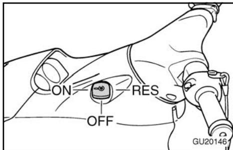
2. Colocar o manípulo da válvula de alimentação de combustível na posição "ON".
