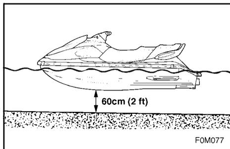
1. Colocar o veículo na água em zonas isentas de algas e detritos e com, pelo menos, 60 cm (2 ft) de altura de água.
