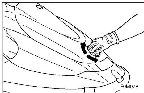
3. Fixar a chave de segurança ① no interruptor de paragem de emergência do motor ②. Fixar também o cabo de paragem de emergência ③ ao pulso esquerdo do operador.
