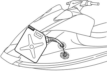
(6) Deje de llenar cuando el nivel llegue aproximadamente a 50 mm (2 in) de la parte superior del depósito. Evite llenar excesivamente el depósito de combustible. Dado que el combustible se expande al calentarse, el calor procedente del motor o del sol puede hacer que el depósito rebose. No deje la moto de agua al sol con el depósito lleno.
