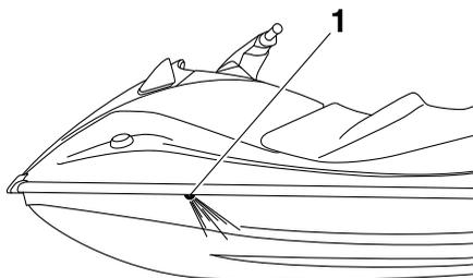
1 Surtidor testigo del agua de refrigeración
