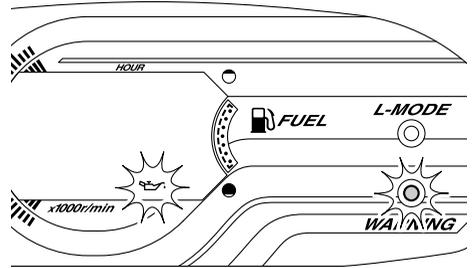
Si la alarma de la presión de aceite se activa, reduzca de inmediato la velocidad del motor, vuelva a tierra y compruebe el nivel de aceite del motor. (Consulte en la página 48 la información relativa a la comprobación del nivel de aceite del motor). Si el nivel de aceite es suficiente, revise la moto de agua en un concesionario Yamaha.
