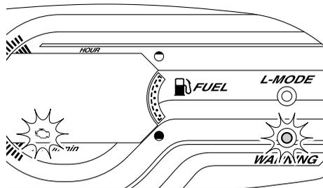
Si se activa la alarma para comprobación del motor, reduzca de inmediato la velocidad del motor, vuelva a tierra y lleve la moto de agua a un concesionario Yamaha para revisión.
